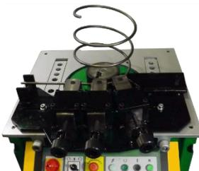
Permette di fabbricare armature a spirale con barre Ø max. 16mm.
